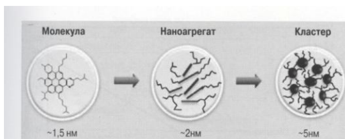
Рис. 1. Нанотеория асфальтенов. При низкой концентрации асфальтенов, например, в конденсатах, асфальтены диспергированы в виде молекулярного раствора. При немного большей концентрации, например, в темных нефтях, асфальтены диспергированы в виде наноагрегатов. При еще большей концентрации, например, в тяжелых нефтях, асфальтены диспергированы в виде кластеров
